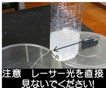
ペットボトルの下の方に穴が空いています。水を入れると穴から水が出ます。穴の反対側からレーザー光を入ると、水の中に!
